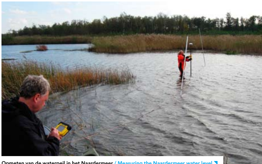
Opmeten van de waterpeil in het Naardermeer / Measuring the Naardermeer water level
